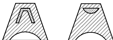
Рис. 2.7. Схема кумулятивных зарядов с линзой
