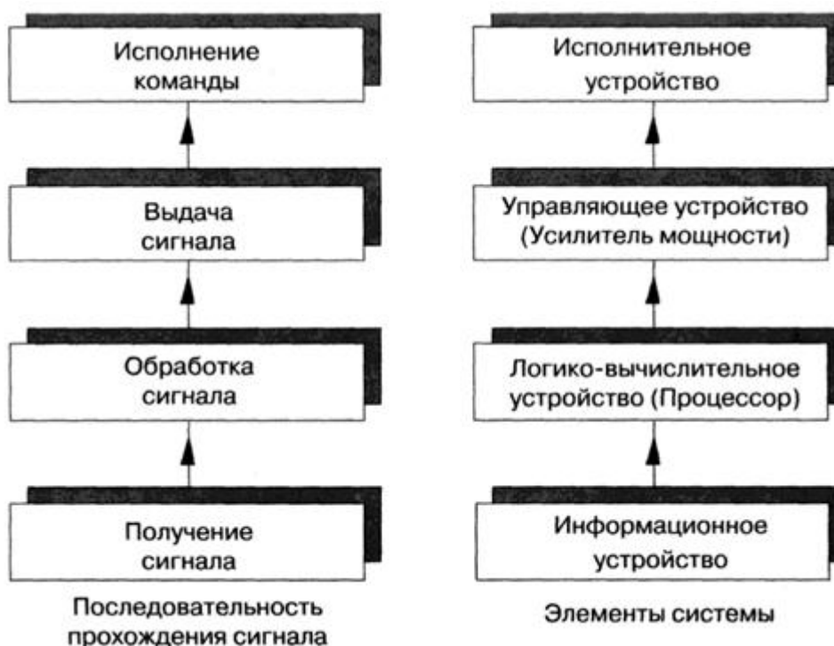
Рисунок 1.10 – Структура пневматической системы и последовательность прохождения сигнала
