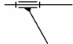
Рисунок 11 – Схема кинематической пары V -го класса 1-го вида
