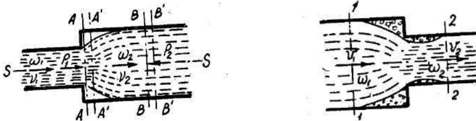
Рис. Г.1. Вход в трубу
